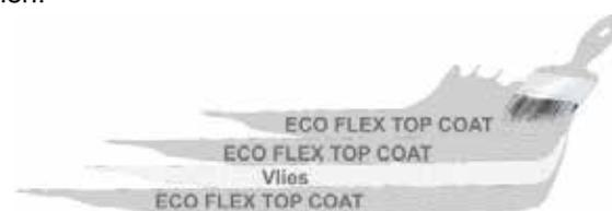
Schichtaufbau ECO FLEX TOP COAT
