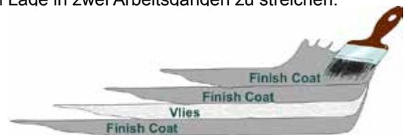
Schichtaufbau Sealoflex Finish Coat System
