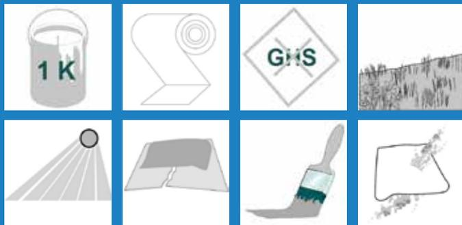
Die Abdichtung ist gebrauchsfertig und kann ohne Anmischen direkt aus dem Eimer verarbeitet werden. Das 2-farbige SEALOFLEX SYSTEM bietet im zweifachen Schichtaufbau eine optische Kontrolle der einzelnen Lagen, was gerade bei größeren Flächen ein Maximum an Sicherheit darstellt. Das SEALOFLEX SYSTEM besteht aus Primer (optional), 1. Lage SEALOFLEX PINK, VLIES, 2. Lage SEALOFLEX PINK und einer Schutzschicht mit SEALOFLEX FINISH COAT.
